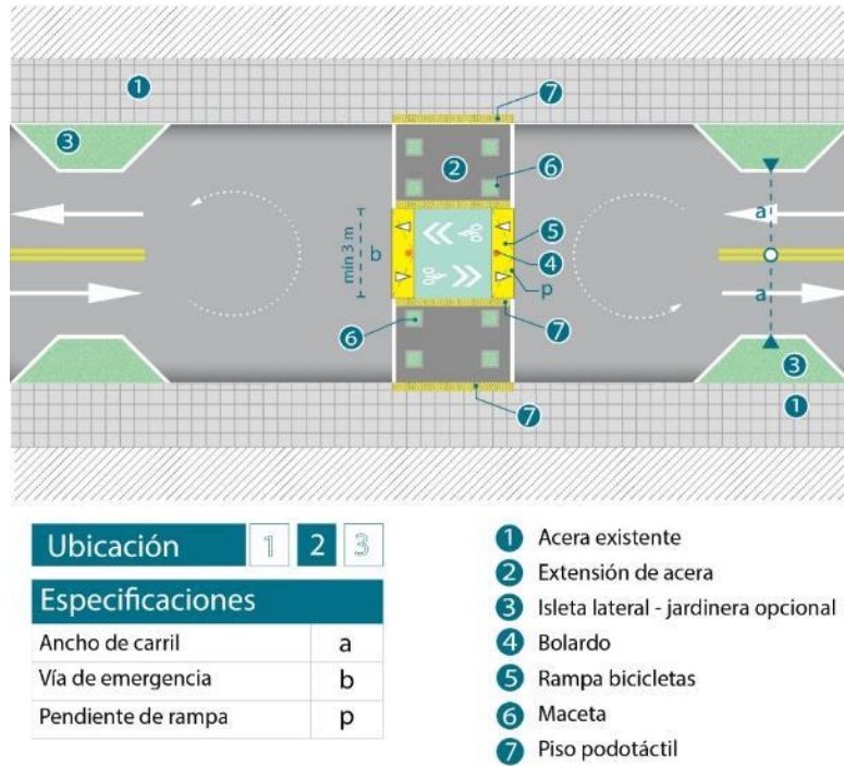
Gráfico No. 103: ESPECIFICACIONES REFERENCIALES DE FONDO DE SACO CON FILTRO MODAL EN "TRAMO VIAL (2)
