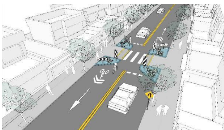
Gráfico No. 86: ESQUEMA REFERENCIAL DE ESTRECHAMIENTO TIPO I CON EXTENSIONES DE ACERA EN "TRAMO VIAL (2)"
