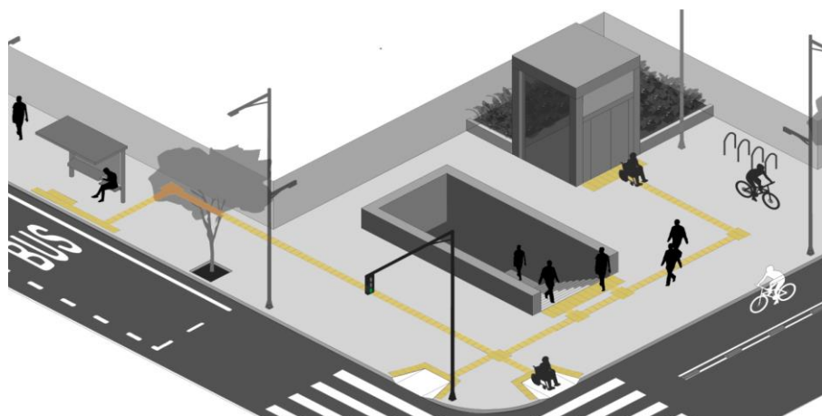
Gráfico No. 51: CONFIGURACIÓN DE SEÑALIZACIÓN HORIZONTAL
