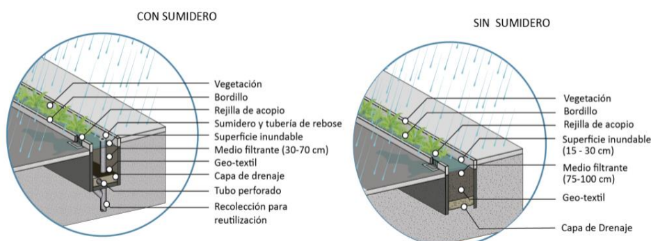
Gráfico 9.1. Tipología de configuración de zanjas de infiltración y ejemplo esquemático de construcción
