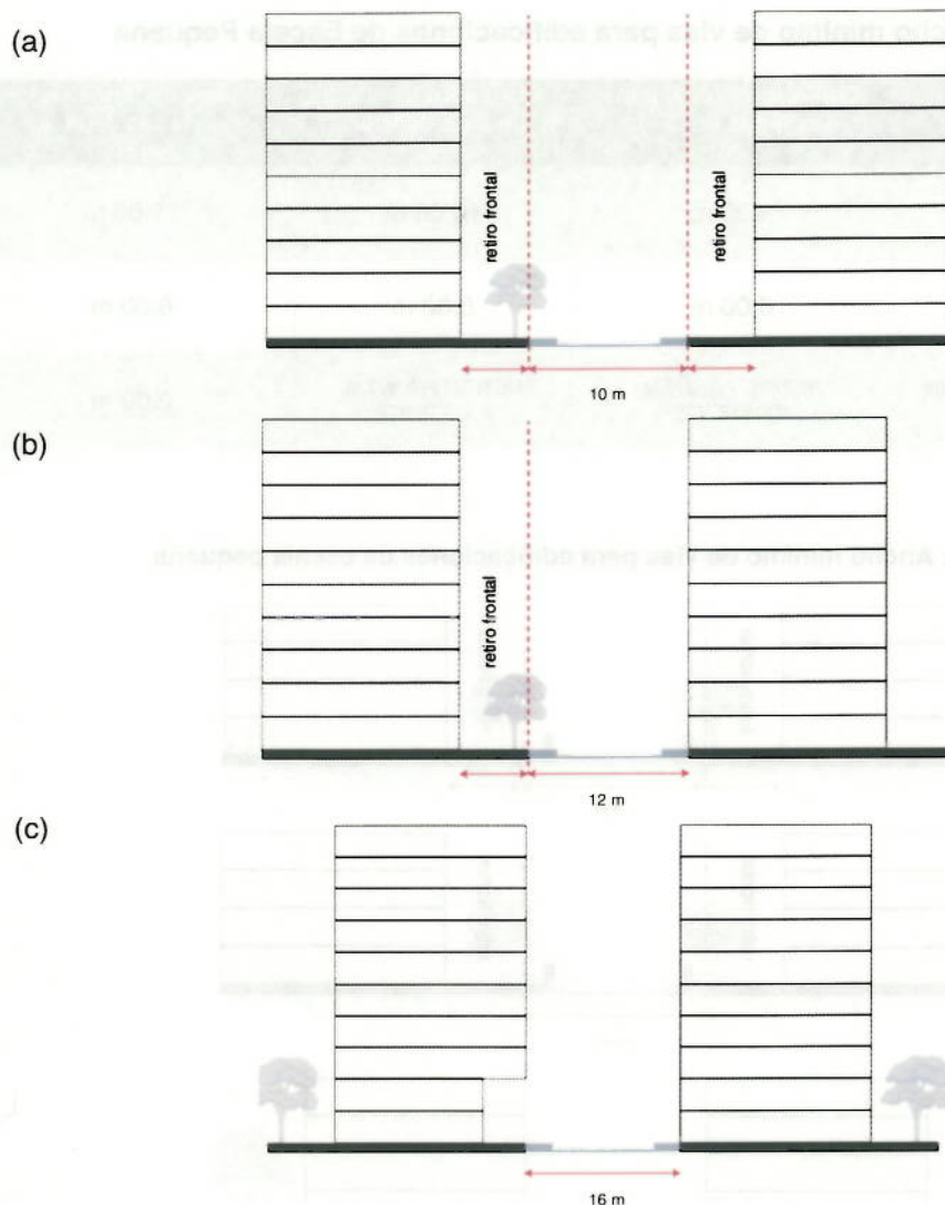
Gráfico 5. Ancho mínimo de vía para los tres casos de la Escala Media.
