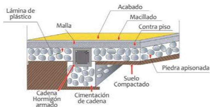
Figura 49: Detalle de contrapiso
