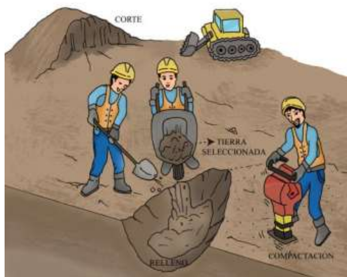
Figura 25: Nivelación del terreno: corte y relleno
