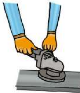
Figura 132: Limpieza de piezas
