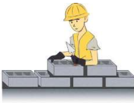
Figura 65: Colocación de bloques trabados
