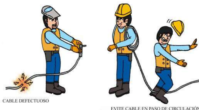
Figura 133: Revisión de cables y conexiones de soldadora
