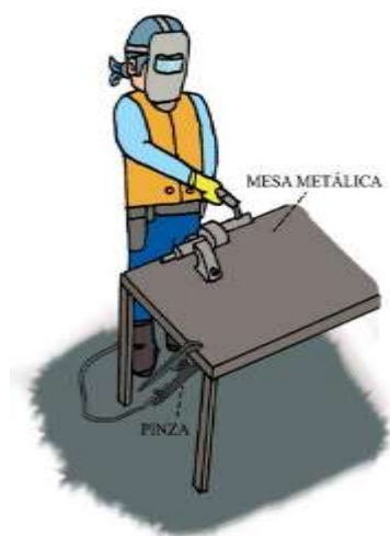
Figura 134: Colocado y aseguramiento de las pinzas de tierra
