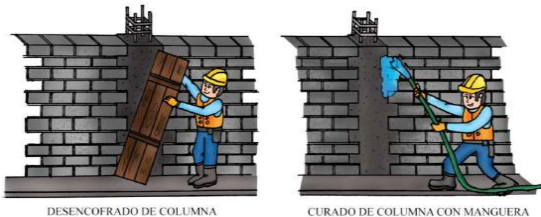
Figura 79: Desencofrado y curado de columnas
