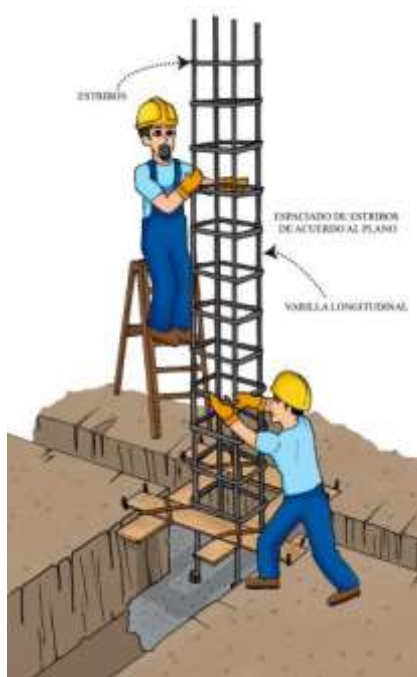
Figura 74: Armado de varillas de acero de columnas
