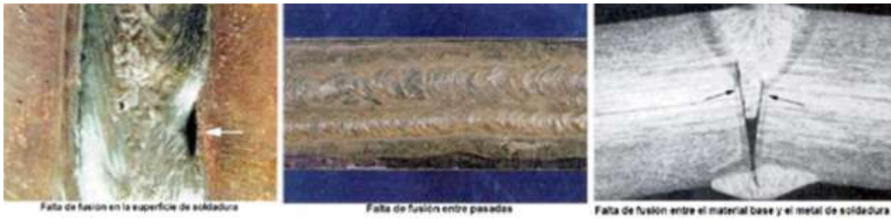
Figura 130: Defectos en la soldadura: fusión incompleta
