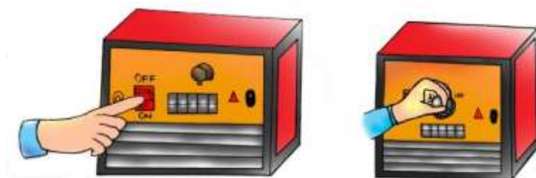
Figura 138: Encendido y regulado de intensidad de soldadora
