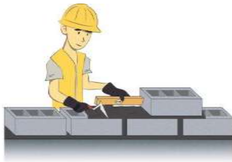
Figura 64: Distribución horizontal del mortero
