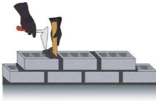
Figura 66: Colocación del mortero en juntas verticales
