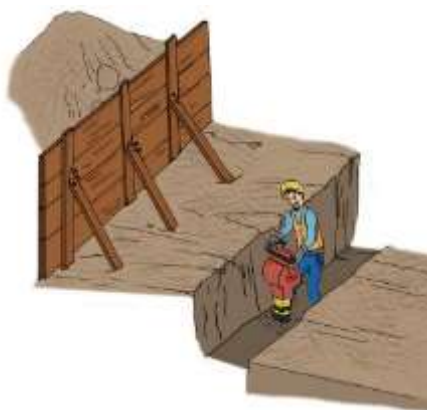
Figura 39: Compactación de fondo de excavación.
