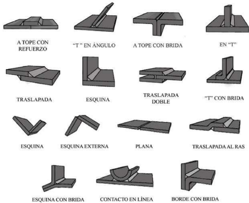
Figura 126: Ejemplos de juntas comunes realizadas con SMAW-GMAW
