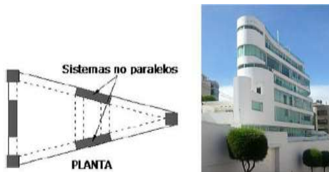
Figura 139: Irregularidad en planta: ejes estructurales no paralelos
