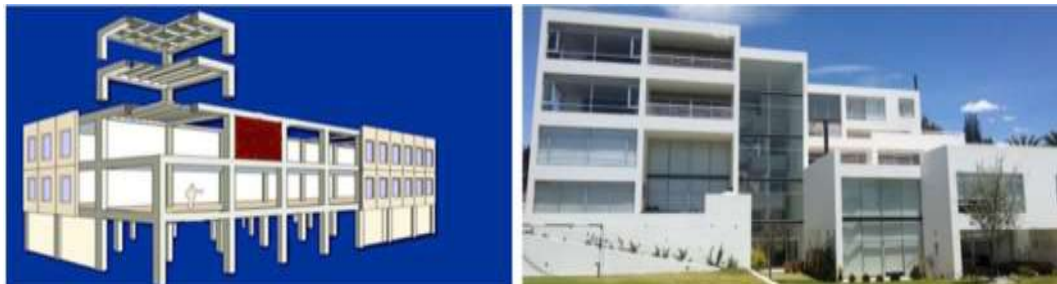
Figura 117: Tipo de sistema estructural: Pórticos de hormigón armado (C1).
