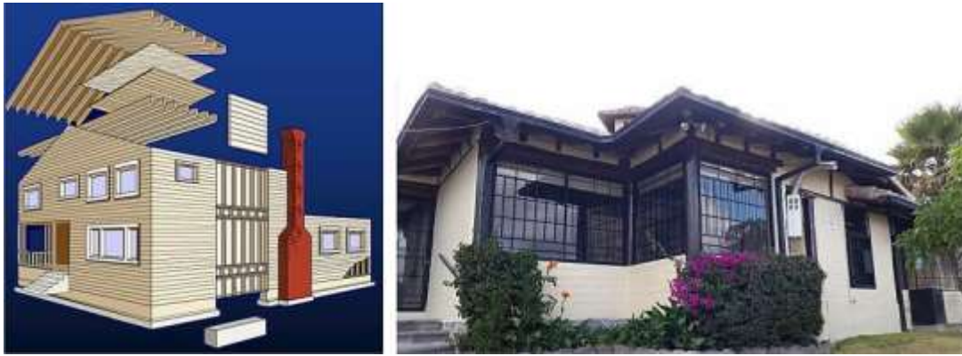
Figura 113: Tipo de sistema estructural: Madera (W1).
