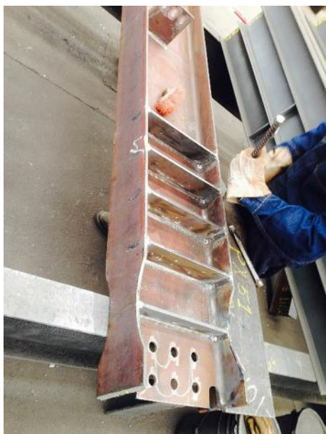
(a) Rigidizador soldado en la sección reducida
