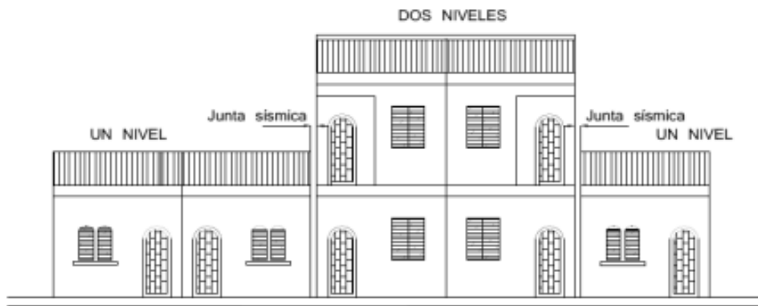
Figura 7: Elevación (c), Ubicación esquemática de las juntas sísmicas de unidades habitacionales multifamiliares
